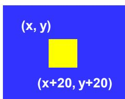
Рассмотрим объект, который движется по экрану. Пусть это будет квадрат со стороной 20 пикселей. При движении координаты всех его точек будут меняться. Чтобы строить квадрат в любом месте экрана, мы выберем его левый верхний угол в качестве базовой (опорной) точки и обозначим ее координаты за **(x, y)**. Координаты противоположного угла будут равны **(x+20, y+20)**.
